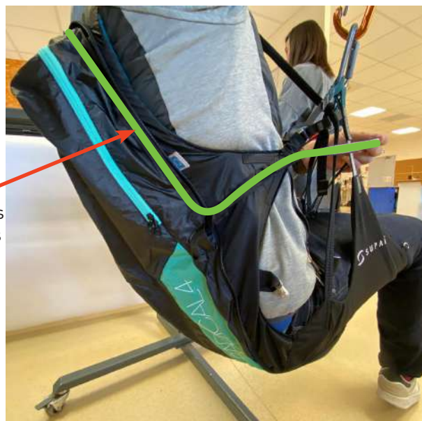
Cheminements des élévateurs
